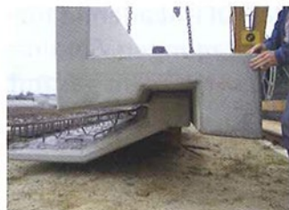
Abb. 3: Die im Betonwerk vorgefertigten, geometrisch anspruchsvollen Fertigteilelemente mit Anschlussbewehrung
